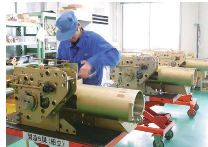
電流のオン・オフを行う高圧遮断機のユニット。 400点の部品からなる。
