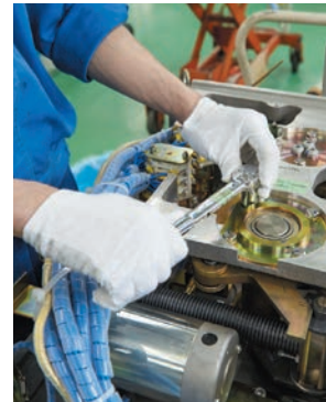
すべてのねじの締め付けをトルクレンチを使って管理しています。
